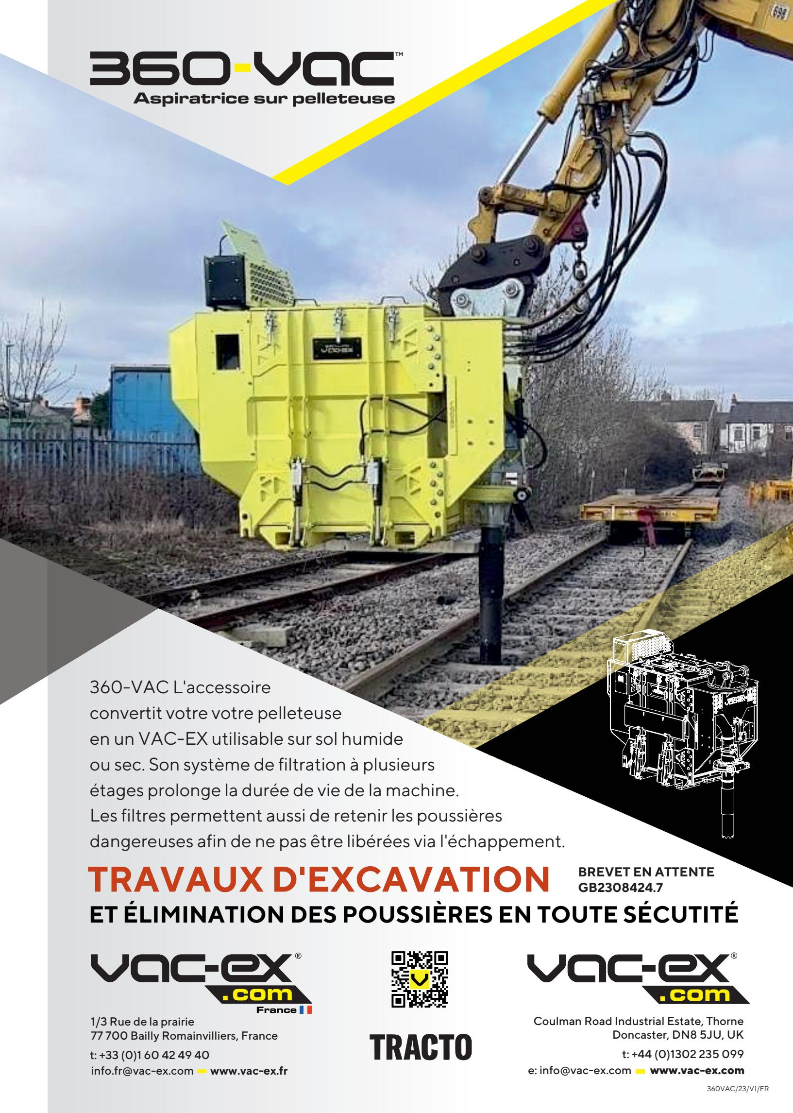
360-VAC L'accessoire convertit votre votre pelleteuse en un VAC-EX utilisable sur sol humide ou sec. Son système de filtration à plusieurs étages prolonge la durée de vie de la machine. Les filtres permettent aussi de retenir les poussières dangereuses afin de ne pas être libérées via l'échappement.
